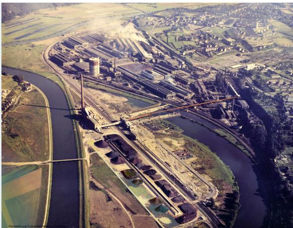
*Das alte und neue Flussbett der Ruhr. Im Vordergrund gut zu sehen, das neue Erzlager mit der Sinteranlage.*
